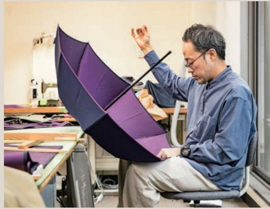
(左)開閉時にスライドさせるロクロを生地で包み込む「ロクロ巻き」で、傘を開く時の指あたりを心地良く。(中央)傘のシルエットを決める生地を断裁。木製の型は、職人1人ひとりが手づくりで作成する。(右)生地が適度な張りを保つよう、調整しながら一針、一針丁寧に縫製していく。
